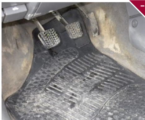
Trwale poplamiona tapicerka, poszycia lub osłony. Zabrudzenia uniemożliwiające usunięcie plam w ramach podstawowego czyszczenia.
