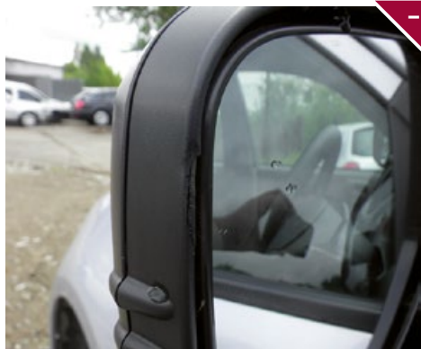
Wszelkie pęknięcia obudowy lusterek.
