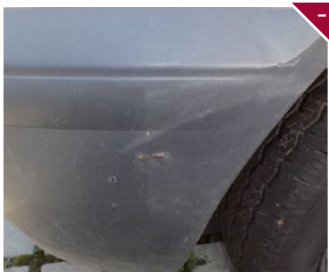
Nieprawidłowe zamocowanie któregośkolwiek z elementów wyposażenia zewnętrznego nadwozia lub uszkodzone uchwyty mocujące.
