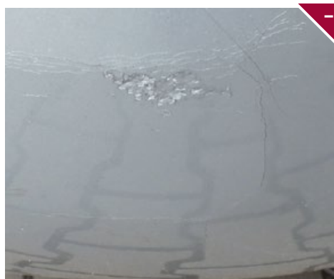
Ślady po odkształceniach zderzaków o powierzchni powyżej 40 mm (z wyłączeniem tylnych nielakierowanych) lub pęknięcia powłoki lakierniczej.
