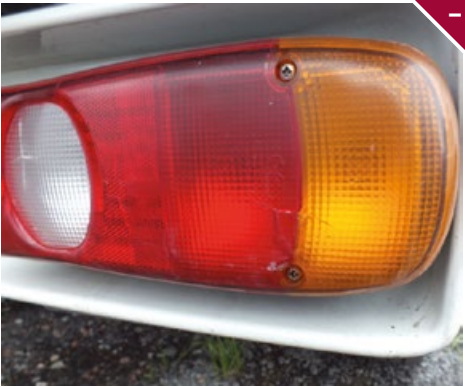
Pęknięcia szkła, pęknięcia przezroczystej osłony.
