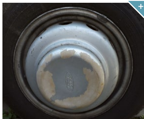
Zarysowania kotłaków i złuszczenie lakieru.
