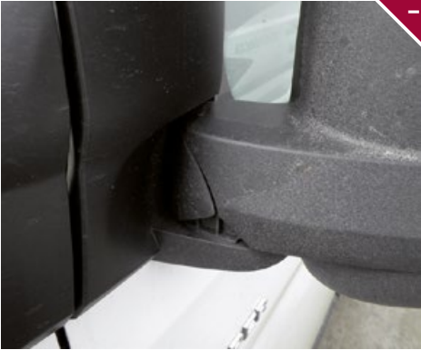
Wszelkie pęknięcia obudowy lusterek.
