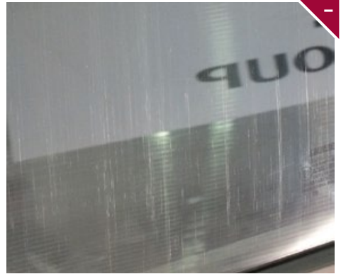
Wszelkie uszkodzenia szyb ograniczające widoczność, np. zarysowania.
