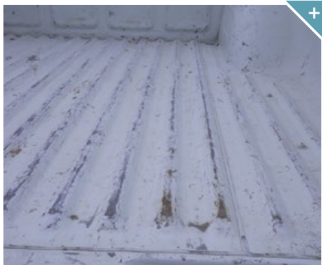
Podłoga przestrzeni ładunkowej ze śladami korozji.
