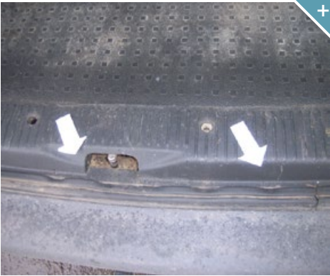
Uszczelki drzwi i pokryw ze śladami prawidłowej eksploatacji, np. odkształcone.
