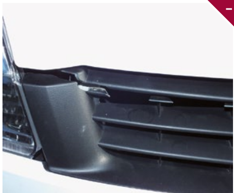
Wszelkie pęknięcia, ubytki lub brak elementów wyposażenia zewnętrznego nadwozia.
